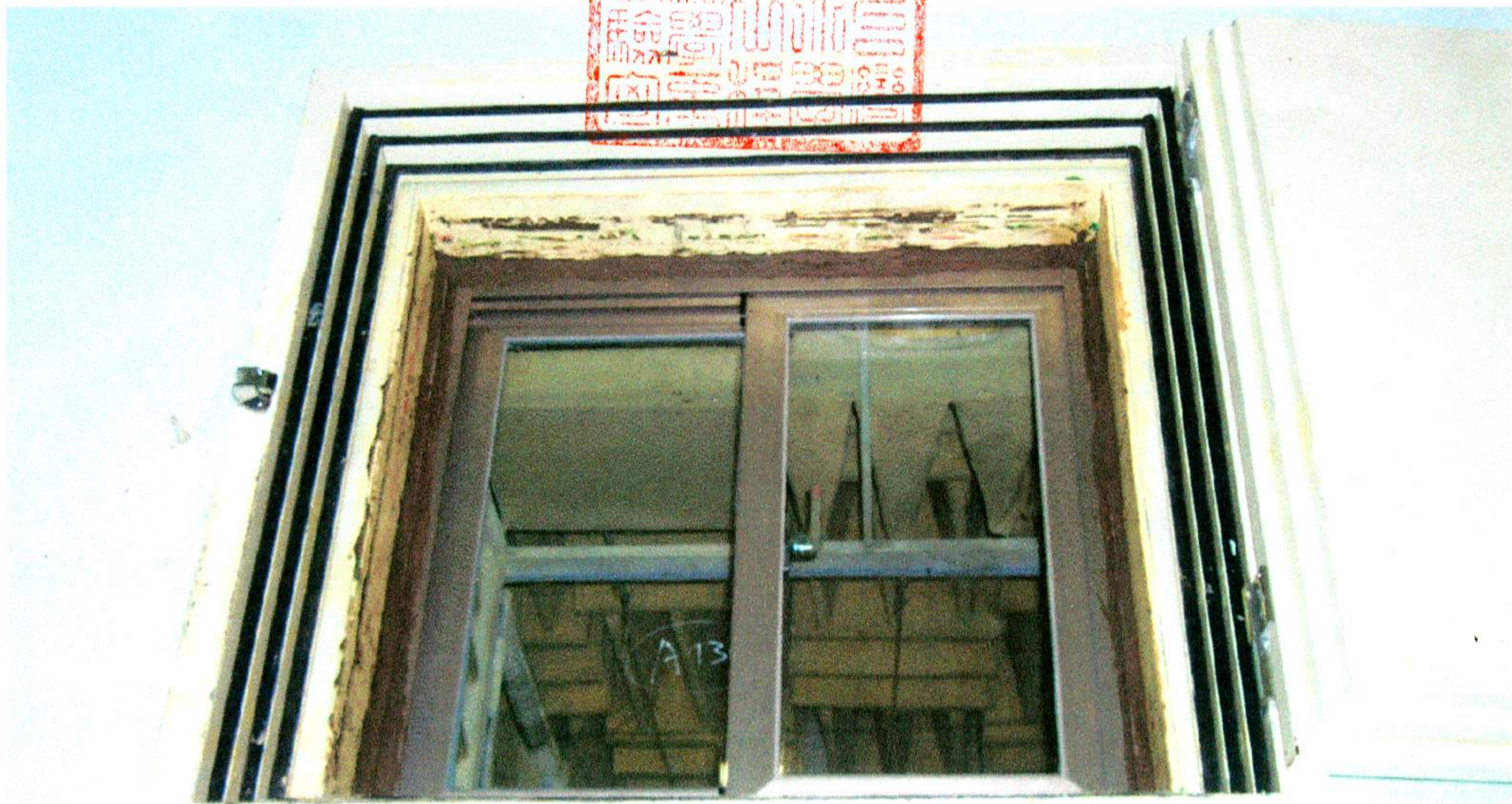
圖 1 試樣佈置圖（無響室）
