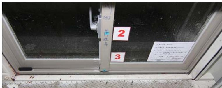
試驗中，試體無漏水現象。
